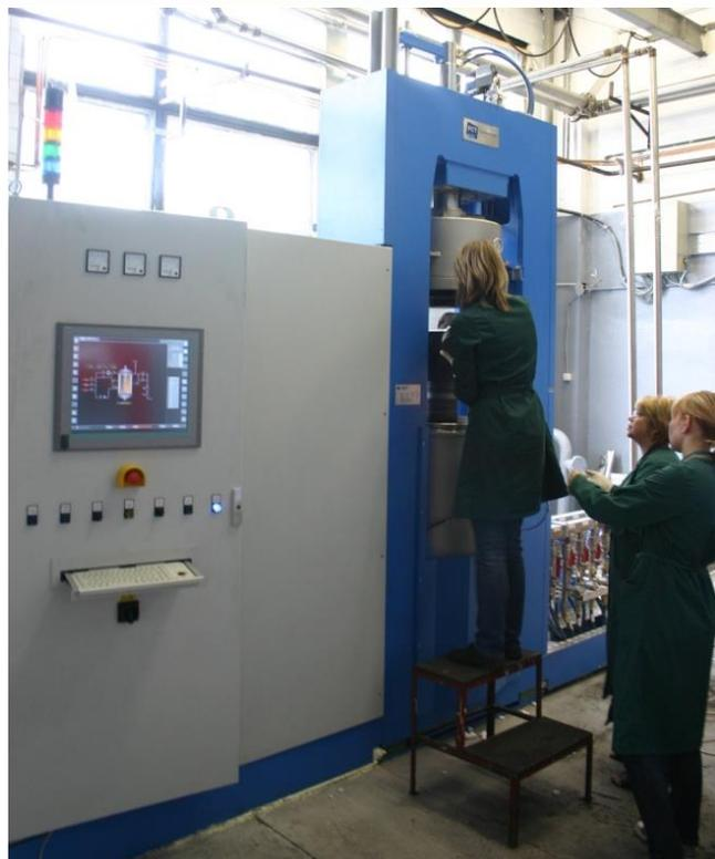
**Высокотемпературный вакуумный горячий пресс HPW 320/460-2200-1250-SD (“HPW 125 SD”), FCT Systeme GmbH, Германия**
