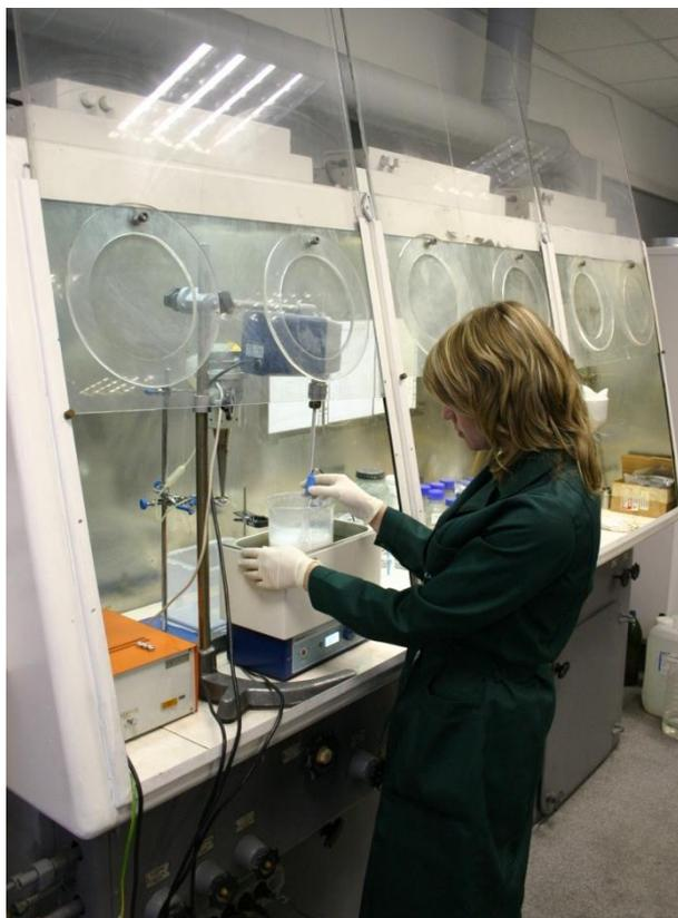
**Модульная установка синтеза композиционных наноразмерных оксидных порошков**
