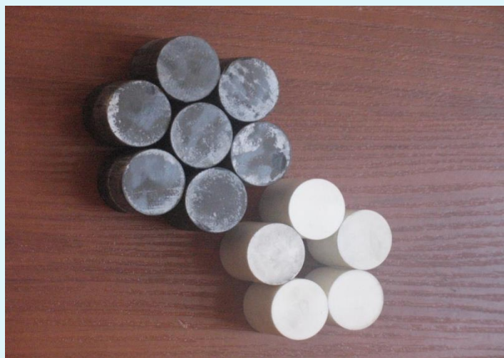
Инструмент для сварки трением из сверхтвердых жаростойких композитов и керамик, конструкции АО «ВНИИАЛМАЗ»
