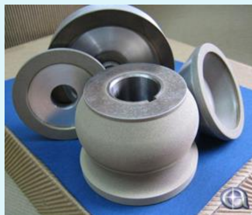
Инструмент с алмазным рабочим слоем, полученным сверхзвуковым газопламенным напылением
